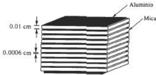
FIGURA 16-34 Capacitor compuesto de capas alternas de aluminio y mica, como ejemplo de un compuesto laminar (para el ejemplo 16-11).
