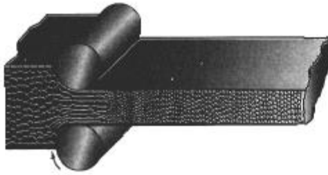
FIGURA 7-20 Durante el trabajo en caliente, los granos alargados anisotrópicos se recristalizan de inmediato. Si la temperatura de trabajo en caliente se controla adecuadamente, el tamaño final de grano por trabajo en caliente puede resultar muy fino.
