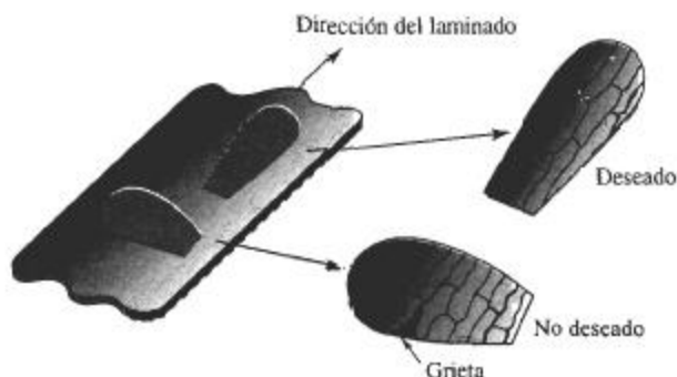
FIGURA 7-10 Orientación de las muestras (para el ejemplo 7-3).
