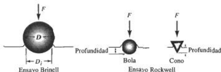
FIGURA 6-11 Ensayos de dureza Brinell y Rockwell.
