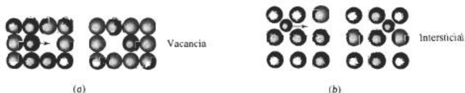
FIGURA 5-3 Mecanismos de difusión en materiales: (a) difusión de átomos por vacancia o por átomos sustitucionales y (b) difusión intersticial.
