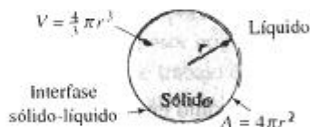
FIGURA 8-1 Se crea una interfase cuando se forma un sólido a partir del líquido.
