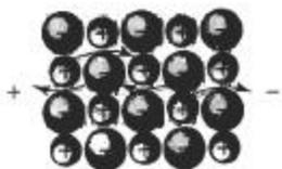
**FIGURA 2-10** Cuando a un material iónico se le aplica voltaje, deben moverse iones completos para que fluya una corriente. El movimiento iónico es lento y la conductividad eléctrica es pobre.
