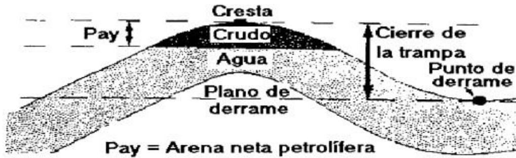
Figura 24: Elementos de una trampa (anticlinal)
