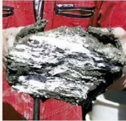
FIGURA 23.A. Esta muestra recogida del fondo oceánico presenta capas de hidratos de gas blancos con apariencia de hielo, mezcladas con barro (Foto cortesía de GEOMAR Research Center, Kiel, Alemania).
