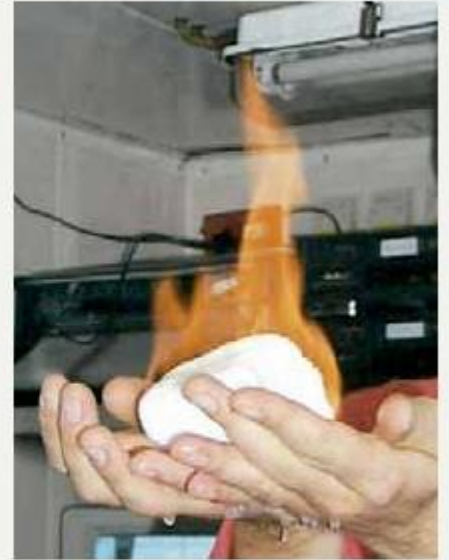
FIGURA 23.B. Los hidratos de gas se evaporan cuando se exponen a las condiciones de la superficie y liberan el gas natural, que puede ser incinerado (Foto cortesía de GEOMAR Research Center, Kiel, Alemania).
