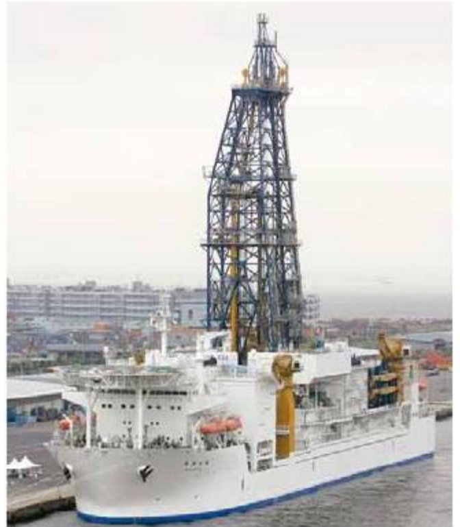
FIGURA 21.4. El Chi-yu (que significa «Tierra» en japonés), el buque perforador científico más avanzado del mundo. Puede perforar a profundidades de hasta 7.000 m por debajo del lecho marino en aguas de hasta 2.500 m de profundidad. Forma parte del programa Integrated Ocean Drilling (IODP) (AP Photo/Itsuo Inouye).
