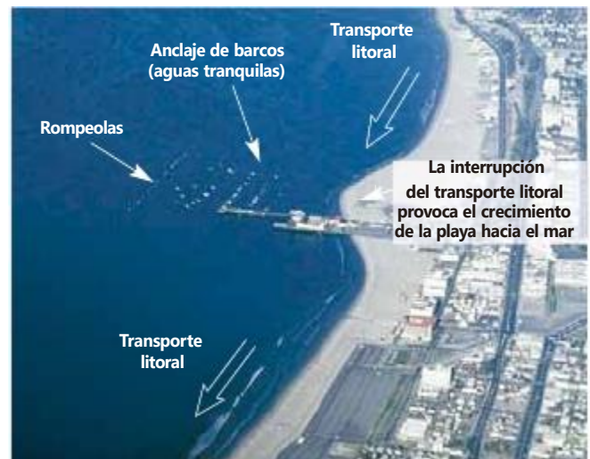
FIGURA 20.21. Vista aérea de un rompeolas en Santa Mónica, California. El rompeolas parece una delgada línea en el agua tras los muchos barcos que están anclados. La construcción del rompeolas interrumpió el transporte litoral y provocó el crecimiento de la playa hacia el mar (Foto por John S. Shelton).
