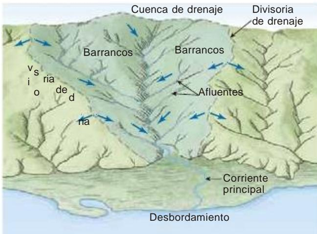
**FIGURA 16.4.** Una cuenca de drenaje es la zona de tierra drenada por una corriente y sus afluentes.
