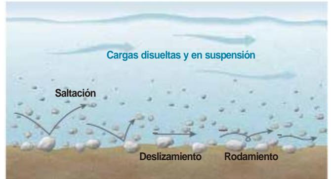
**FIGURA 16.12.** Las corrientes de agua transportan su carga de sedimentos de tres formas. Las cargas disueltas y en suspensión son transportadas en el flujo general. La carga del fondo consiste en arena gruesa, gravilla y bloques que viajan rodando, deslizándose y por saltación.
