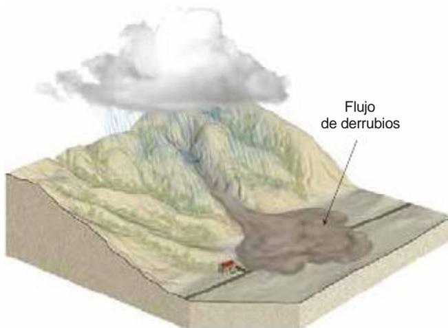
**FIGURA 15.17.** El flujo de derrubios es una lengua de barro bien mezclado, suelo, roca y agua en movimiento. Su consistencia puede variar desde la parecida a cemento mojado hasta la de una mezcla con textura de sopa menos densa que el agua embarrada.
