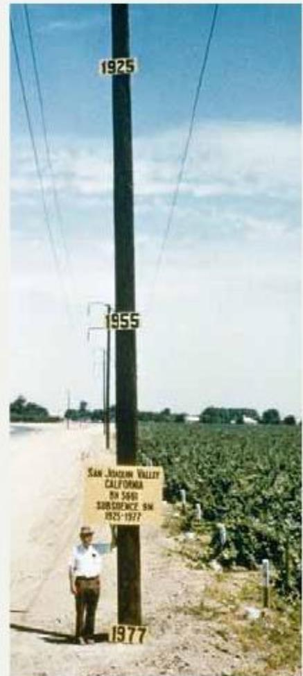
**FIGURA 17.D.** Las marcas en este poste indican el nivel de la tierra circundante en los años anteriores. En 1925 y 1975 esta parte del valle de San Joaquín Valley cedió unos 9 m debido a la extracción de agua subterránea y a la compactación de los sedimentos resultantes (Foto cortesía de la U.S. Geological Survey).
