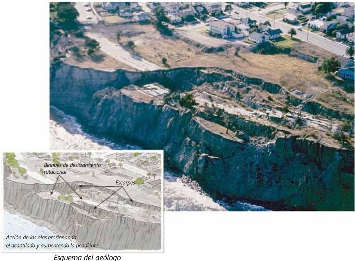
**FIGURA 15.14.** Deslizamiento rotacional en Point Fermin, California. Con frecuencia el deslizamiento rotacional se desencadena cuando las pendientes adolecen de un exceso de pendiente causado por procesos de erosión como la acción de las olas (Foto de John S. Shelton).
