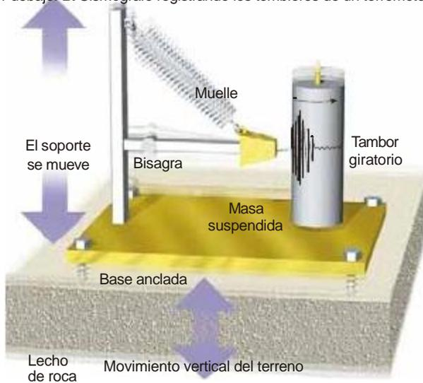
**FIGURA 11.10.** Sismógrafo diseñado para registrar el movimiento vertical del terreno.
