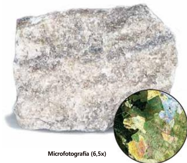
FIGURA 8.17. Mármol, roca cristalina formada por el metamorfismo de calizas. La microfotografía muestra mediante la luz polarizada cristales de calcita entrelazados (Fotos de E. J. Tarbuck).
