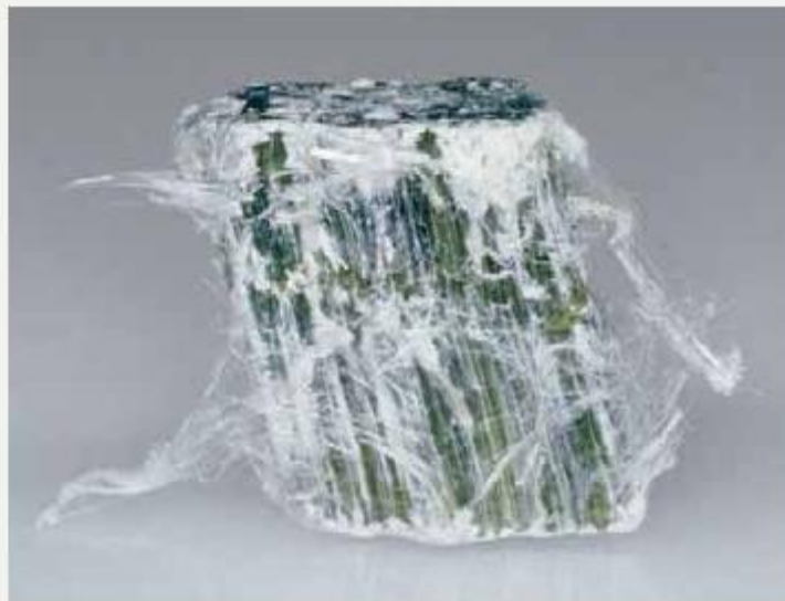
FIGURA 3.B. Asbesto de crisotilo. Esta muestra es una forma fibrosa del mineral serpentina (Foto de E. J. Tarbuck).
