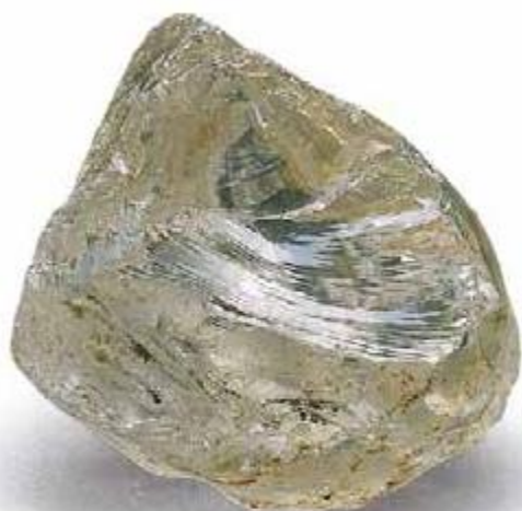
FIGURA 3.24. Fractura concoidea. Las superficies curvas lisas se producen cuando los minerales se rompen como el vidrio (Foto de E. J. Tarbuck).
