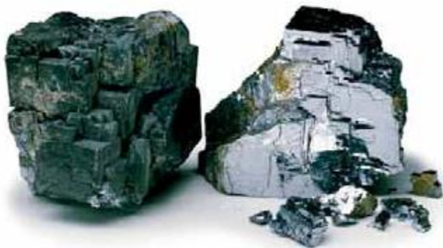
FIGURA 3.17. La muestra recién rota de la galena (derecha) exhibe un brillo metálico, mientras que la muestra de la izquierda está deslustrada y tiene un brillo submetálico (Foto cortesía de E. J. Tarbuck).
