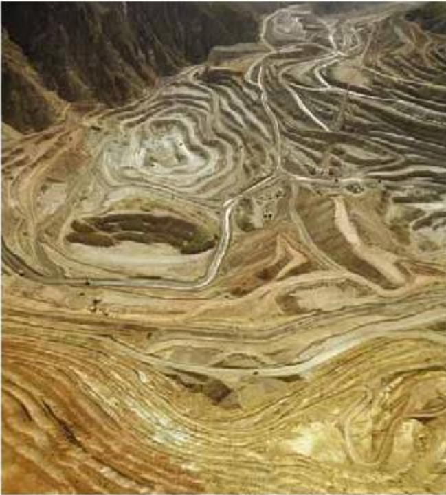
FIGURA 1.4. La mina de cobre a cielo abierto en Morenci, Arizona, es una de las mayores productoras de cobre en Estados Unidos. Cuando la demanda de cobre es grande, la mina funciona sin interrupción, procesando 700.000 toneladas de roca al día y produciendo unos 389 millones de kilogramos de cobre al año (Foto de Michael Collier).
