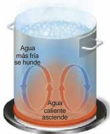
FIGURA 2.32. La convección es un tipo de transferencia de calor que implica el movimiento real de una sustancia. Aquí el fuego calienta el agua en el fondo de una cazuela. El agua caliente se expande, se vuelve menos denso (más flotante) y asciende. A la vez, el agua más fría y más densa cerca de la superficie, se hunde.
