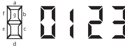
Figura 6.15 Display de siete segmentos.
