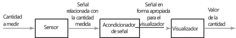
Figura 1.7 Un sistema de termómetro digital.
