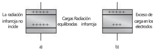
El sensor piroeléctrico se comporta como un generador de carga, que la genera cuando hay un cambio en su temperatura como resultado de la incidencia de radiación infrarroja. En la parte lineal de la gráfica de la Figura 2.28c), cuando la temperatura cambia, el cambio de la carga  $\Delta q$  es proporcional al de temperatura  $\Delta t$ :
