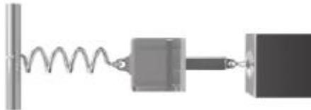
**Figura 6.1** Sistema masa resorte amortiguador.
