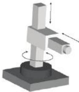
**Figura 5.19** Robot en configuración cilíndrica.
