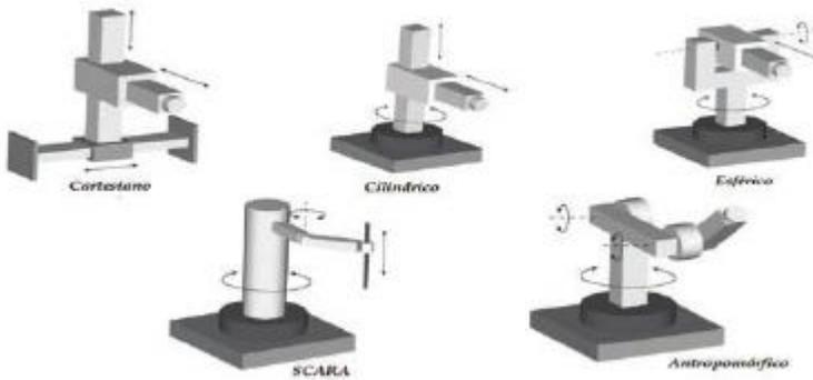
**Figura 4.4** Clasificación de los robots industriales.
