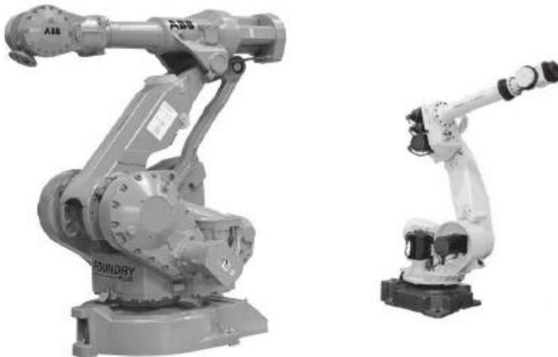
**Figura 5.7** Robots industriales en configuración antropomórfica: ABB y FANUC.
