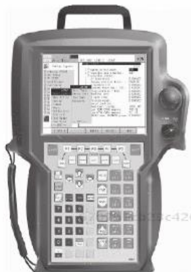
Figura 6.29 Teach pendant del robot 2000iA/165F FANUC.
