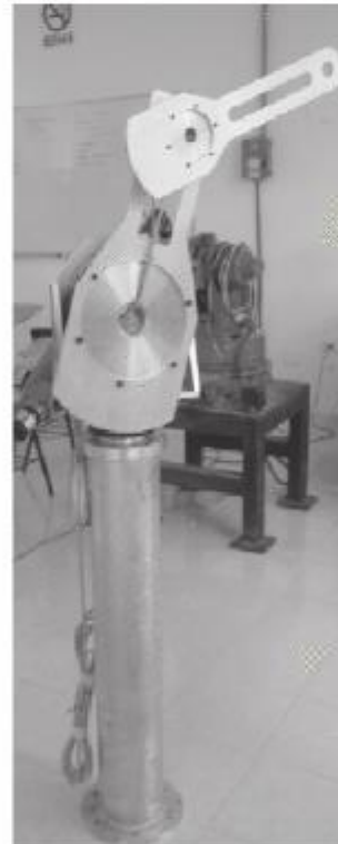
Figura 5.7 Rotradi robot experimental de transmisión directa de 3 gdl.
