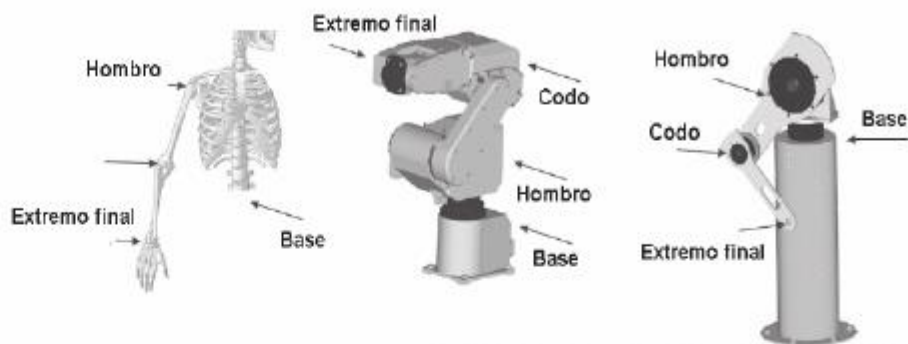
Figura 4.6 Base, hombro y codo de un robot industrial.
