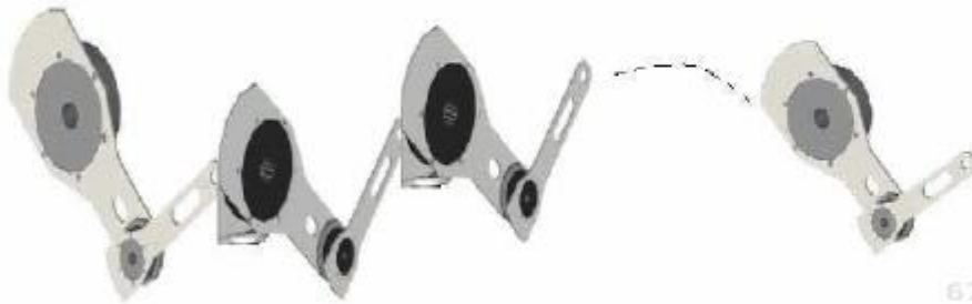
Figura 4.2 Robot manipulador formado por cadena cinemática abierta.
