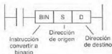
Figura 19.46 Decimal codificado en binario (BCD) a binario
