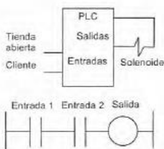
Figura 19.15 Sistema de la puerta de una tienda
