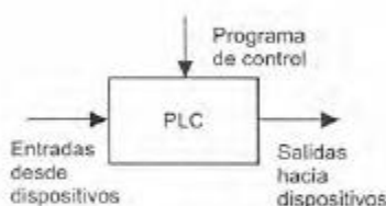
Figura 19.1 Controlador lógico programable (PLC)
