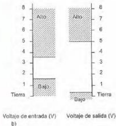
Figura 14.15 Definición de valor alto y valor bajo: a) TTL, b) CMOS
