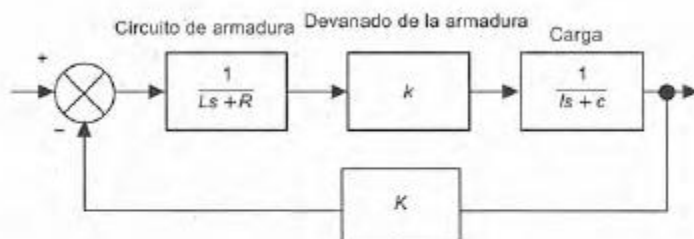
Figura 11.6 Motor de cd controlado por armadura
