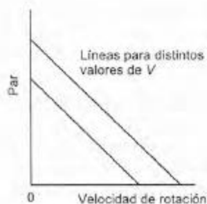
Figura 7.25 Características del par de rotación-velocidad
