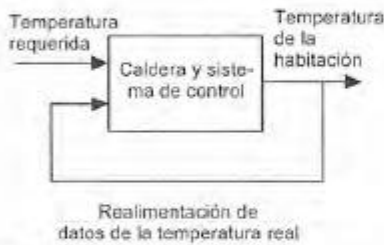
Figura 1.6 Control por realimentación de la temperatura de una habitación
