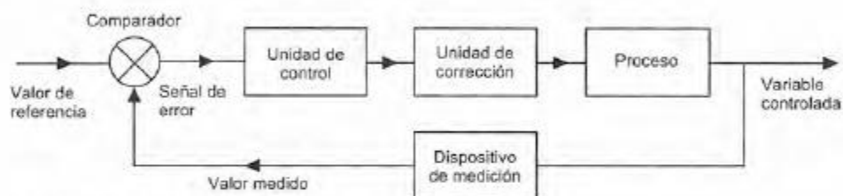
Figura 1.9 Elementos de un sistema de control en lazo cerrado
