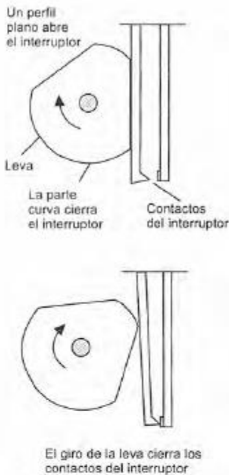
Figura 1.13 Interruptor operado por levas
