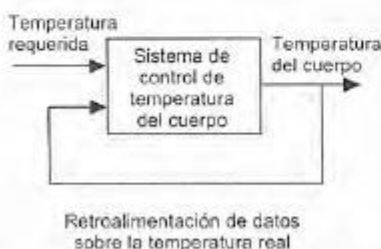
Figura 1.5 Control realimentado de temperatura del cuerpo humano.
