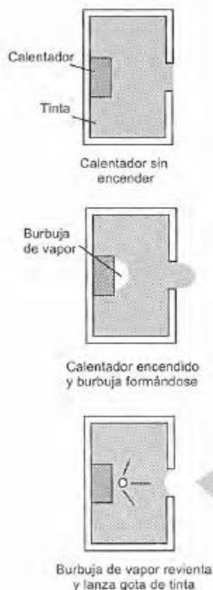
Figura 4.11 Principio del chorro de burbujas
