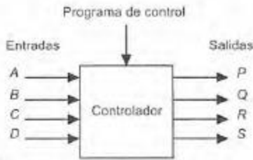
Figura 1.14 Controlador lógico programable (PLC)
