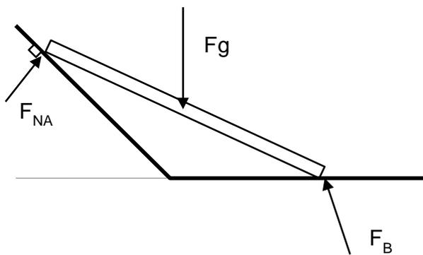
En este caso, por facilidad de análisis, es conveniente en la articulación "B" descomponer la reacción en dos, una componente horizontal " $F_{Bx}$ " y otra vertical " $F_{By}$ ". Así:
