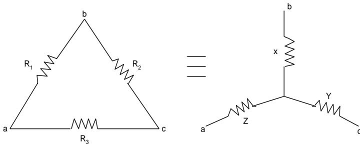
$$x = \frac{R_1 R_2}{R_1 + R_2 + R_3} \quad y = \frac{R_2 R_3}{R_1 + R_2 + R_3}$$
