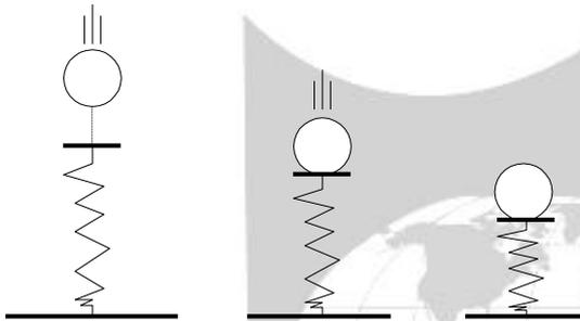
(b) El gas se desplaza levantando el émbolo superando la resistencia ofrecida por la carga hasta una determinada distancia, originado por la presión interna del gas.
