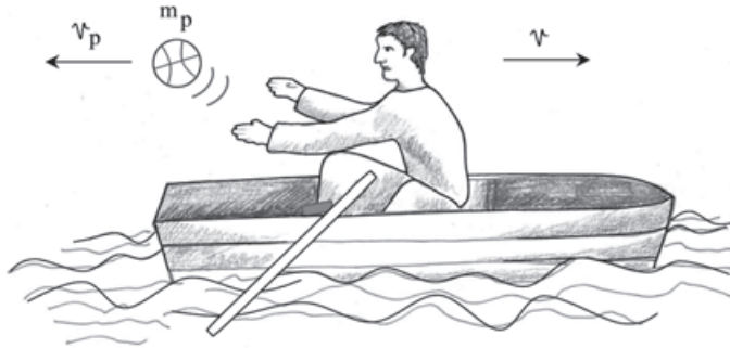
Fig. 2.31. Al lanzar un objeto en una dirección, el resto del sistema (bote, persona, objeto, etc.), inicialmente en reposo, retrocede en la dirección contraria debido a la conservación del momento.
