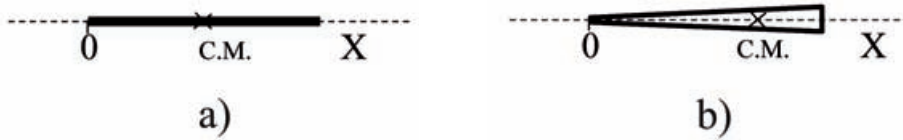
Fig 2.24. Varilla unidimensional: (a) de densidad uniforme, (b) de densidad proporcional a la distancia a uno de sus extremos.
