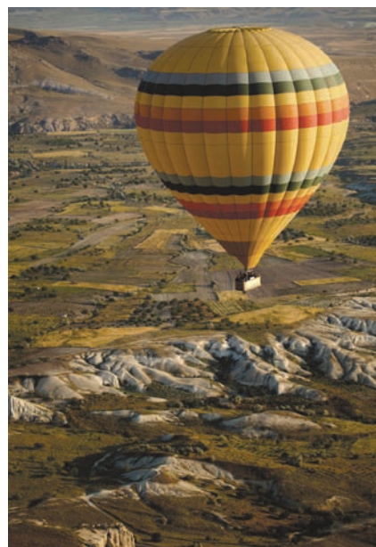
Figura 1.5 Al calentar el aire dentro del globo, éste pesará menos que el aire exterior y, por tanto, recibirá una fuerza de empuje hacia arriba que hará ascender el globo aerostático.
