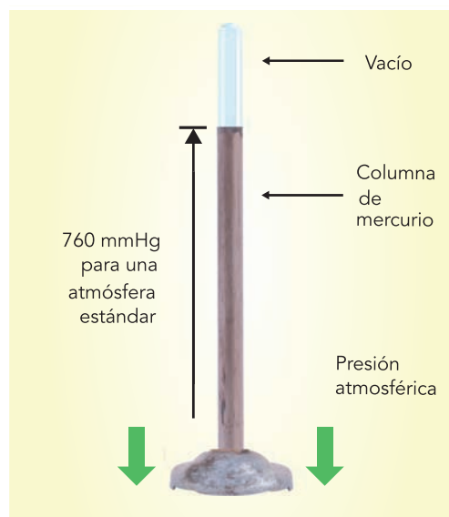
Figura 1.10 Torricelli comprobó que el mercurio llega hasta una altura de 76 cm (760 mmHg), que se conoce como presión atmosférica.
