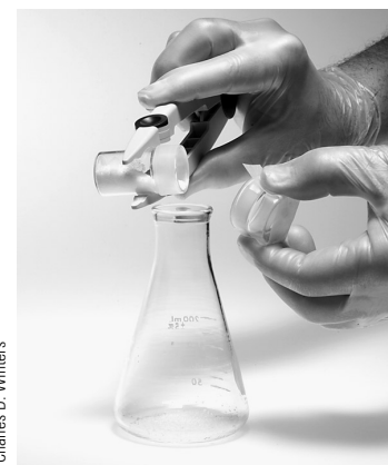
Figura 2-10 Transferência quantitativa de uma amostra sólida. Observe o uso da pinça para segurar o pesa-filtro e de uma tira de papel para segurar a tampa e evitar o contato da pele com o vidro.
