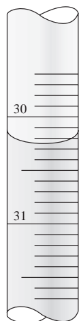
Figura 6-5 Seção de uma bureta mostrando o nível do líquido e o menisco.
