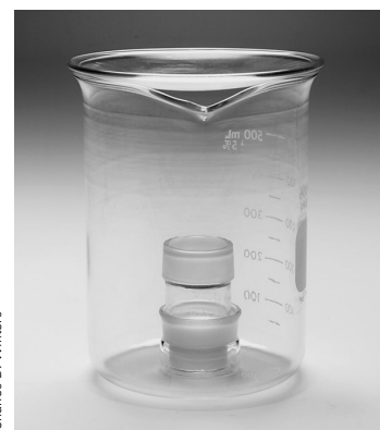
Figura 2-9 Arranjo para a secagem de amostras.
