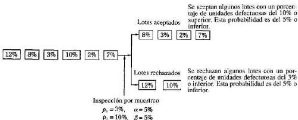
Figura 6.9: Ejemplo de inspección por muestreo basada en p_0, \alpha, p_1, \beta
