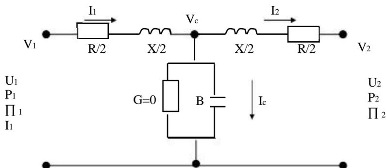
Fig. 4.15 Circuito empleado para el método del circuito equivalente en T
