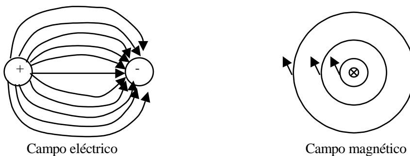
Fig. 2.17 Campo eléctrico y campo magnético. Distribución de líneas de fuerza
