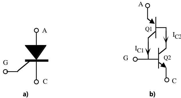
Figura 12.8. a) símbolo del SCR, b) Modelo a nivel de transistor.
