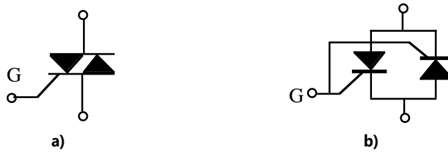
Figura 12.18. a) Símbolo del TRIAC y b) Modelo equivalente en SCRs.
