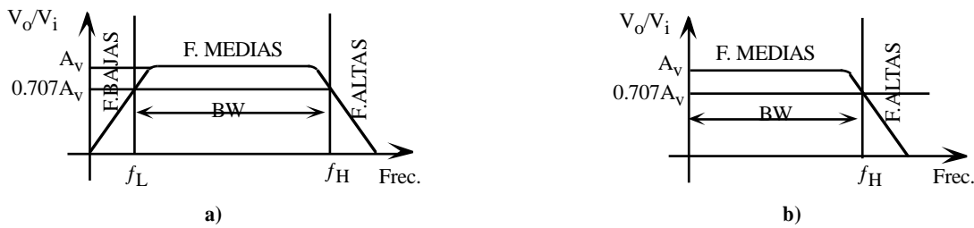
Figura 3.1. Ganancia de un amplificador frente a la frecuencia para a) amplificador general, b) amplificador sin condensadores de acoplo y desacoplo (amplificador directamente acoplado).
