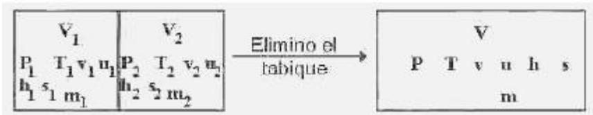
Imaginemos un sistema en el que hay dos gases ideales en estados distintos caracterizados por sus propiedades  $P$ - $V$ - $T$ , separados por un tabique removible. Se quita el tabique. El sistema experimenta una transformación en la que se igualan las condiciones  $P$ - $V$ - $T$ , y además se mezclan los gases.
