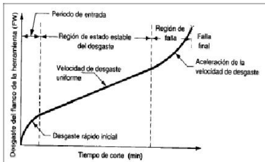
Figura 15 Desgaste de herramientas de corte
