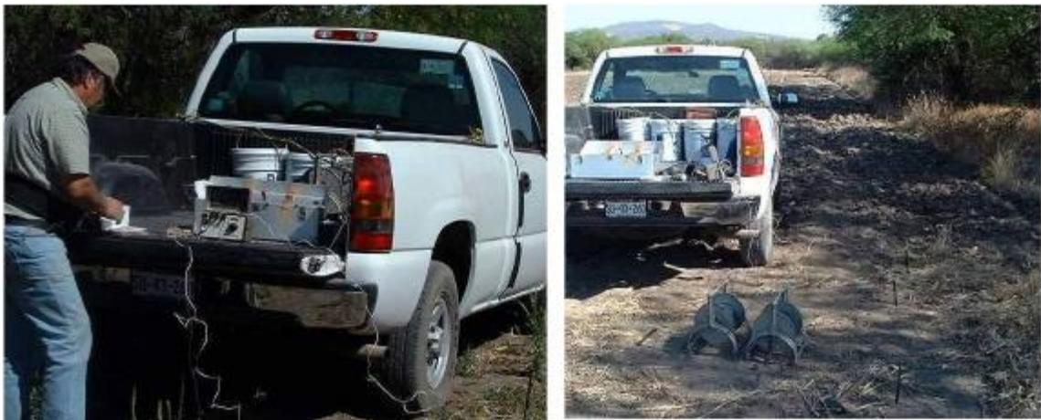
Fig 2.22. Resistímetro, cables electrodos y tendidos
