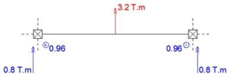
Acciones de empotramiento perfecto para un momento de 3.2 Tm.
